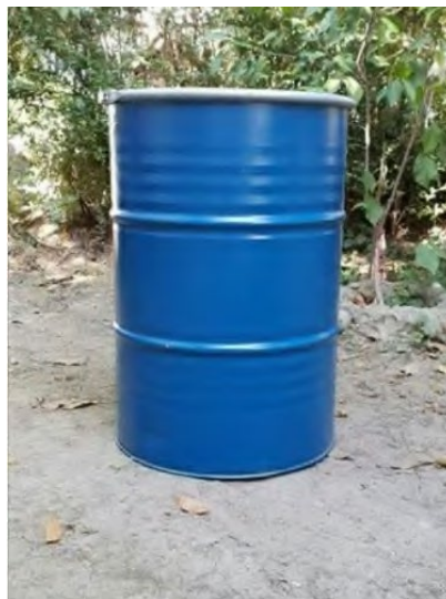
Слика 18 - Судови за складиштење уља и масти из сепаратора
