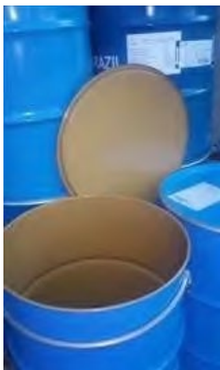
Слика 18 - Судови за складиштење уља и масти из сепаратора
